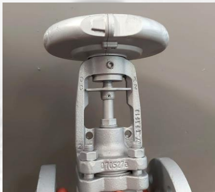
Lackierte Haube auf Armatur
